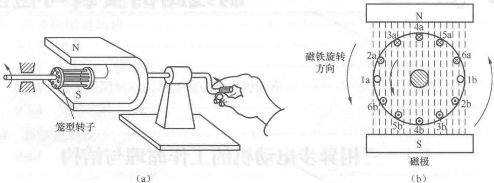
图 1-2 笼型转子旋转原理
