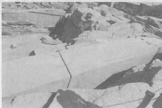
图 1.2-7 古埃及阿斯旺采石场 (柱子在采石场凿制好后再运到工地安装)
