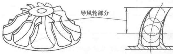
图 1-11 导风轮的结构及通道
