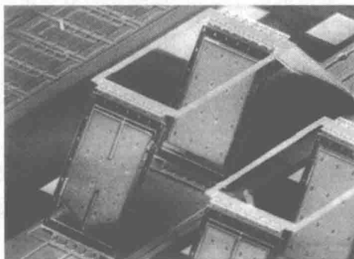
图 1.6 由芯片内部装配机构立起的微平面镜
