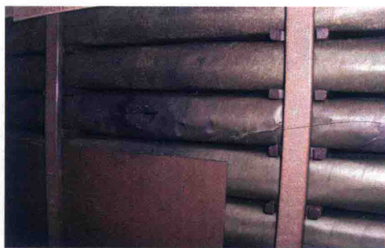
图 2-8 阀侧线圈放电位置
