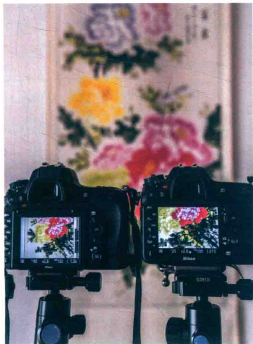
图 1-1-9 50mm 焦距的镜头分别装载在尼康 D750 (左,全画幅)和尼康 D7500 (右,APS-C画幅)上的拍摄范围对比。
