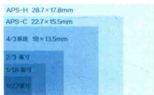
图 1-1-2 感光材料画幅大小示意图
