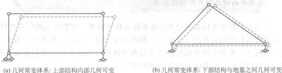
(a) 几何常变体系: 上部结构内部几何可变
