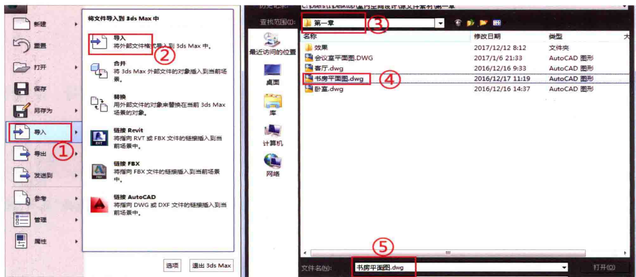
图 2-1 导入书房平面 CAD 图纸
