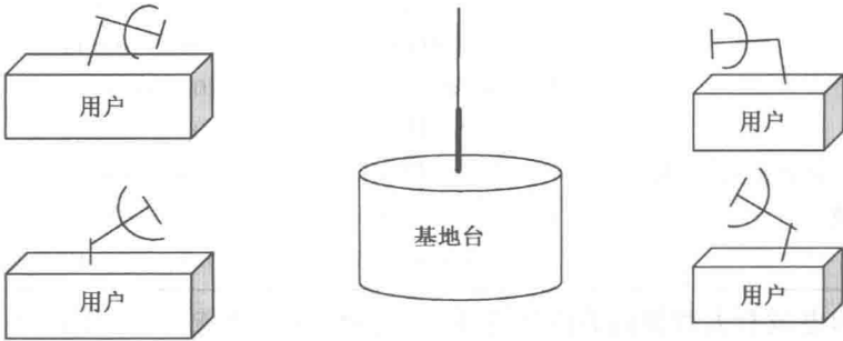
图 1-2 微波一点多址通信系统示意图
