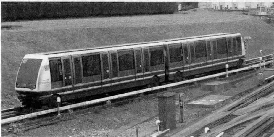
图 1.6 法国里尔地铁（Métro de Lille）的 VAL 系统
