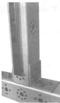
图 1-18 装有导轨的 C 形型材与角件的固定
