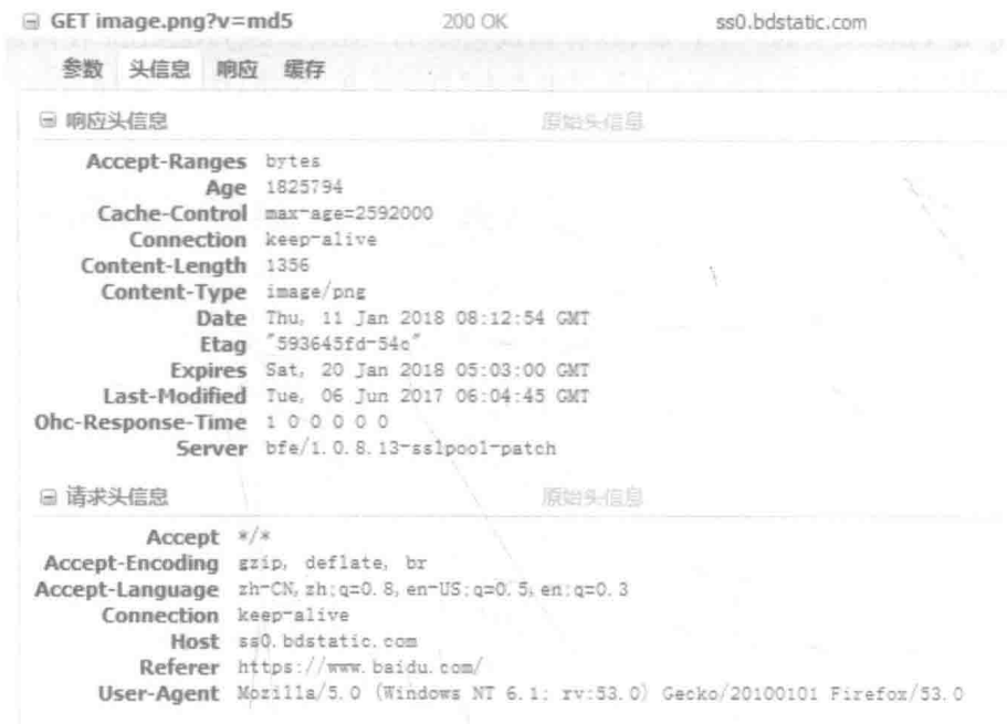
图 1-13 Firebug 插件显示 HTTP 请求
