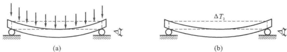
图 1-1 作用与效应 (a)直接作用(重力);(b)间接作用(升温)
