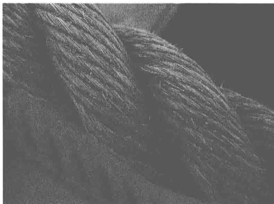
图 1-10 典型三股捻绳结构示意图
