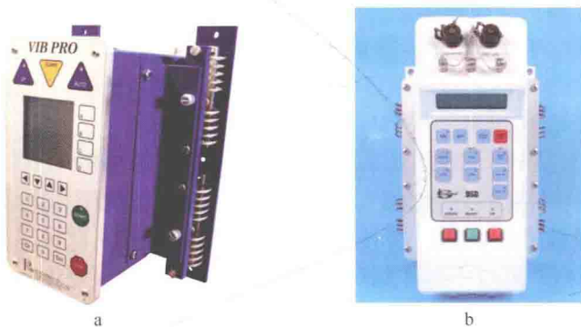
图 1-3 美国 ION 公司 VIB PRO 电控箱体 (a) 和法国 Sercel 公司 VE464 电控箱体 (b)
