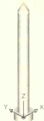
用 AutoCAD 绘制由两个圆柱体及一个圆锥体组成的模具导针是比较简单的，通过本实例的学习来掌握 AutoCAD 中实体工具箱里的基本三维形体绘制工具。
