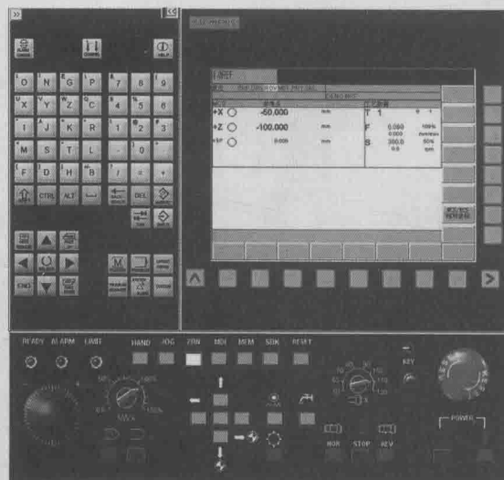
图 1-1 SIEMENS 802D 系统面板图
