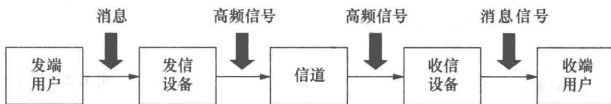
图 1.3.1 通信系统构成图
