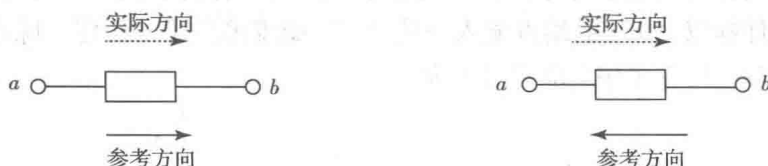
图 1-7 电流参考方向与实际方向的关系
