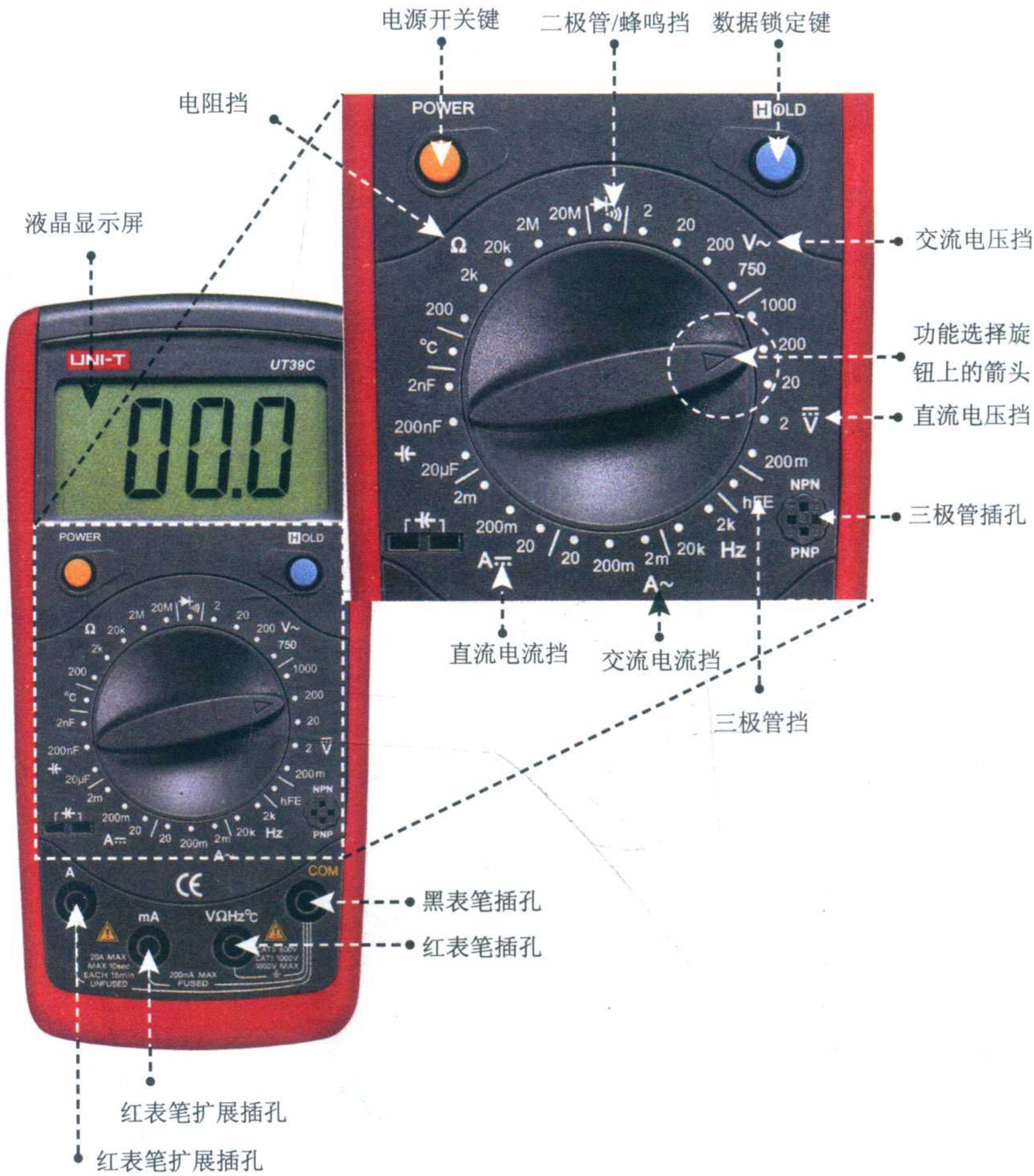
图1-7 数字万用表的结构
