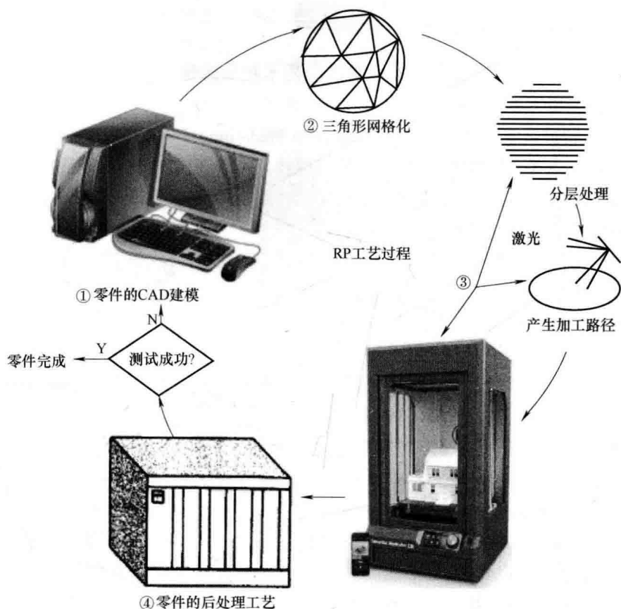
图 1-3 3D 打印技术原理
