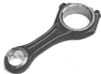
图 0-11 曲柄滑块机构中的连杆
