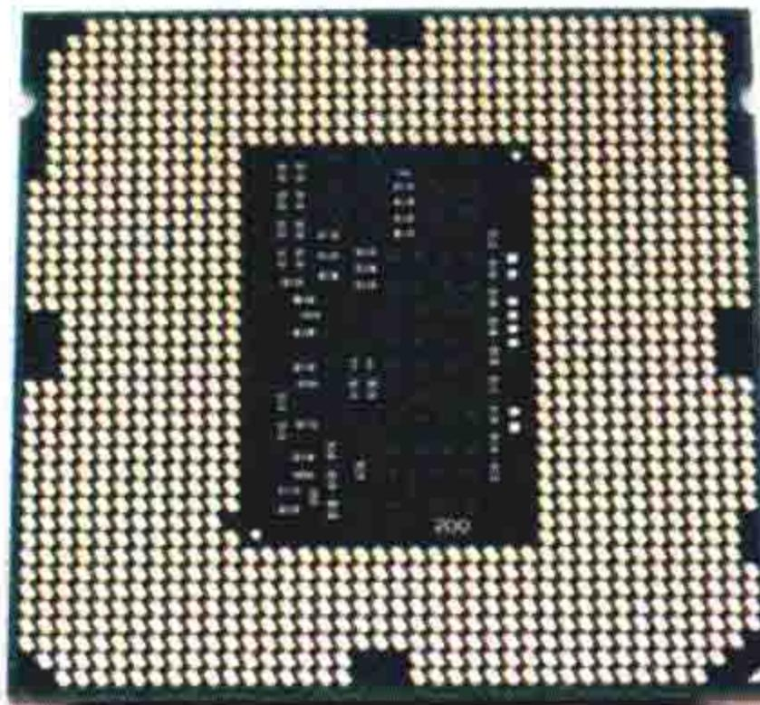
AMD 的 Socket 封装主要有 SocketAM2 和 AM3。Socket 封装的 CPU 仍然为传统的针脚式（如下图所示），插到主板上的 Socket 零拔力（ZIF）插槽上，通过压杆使 CPU 的引脚与插槽紧密地接触。
