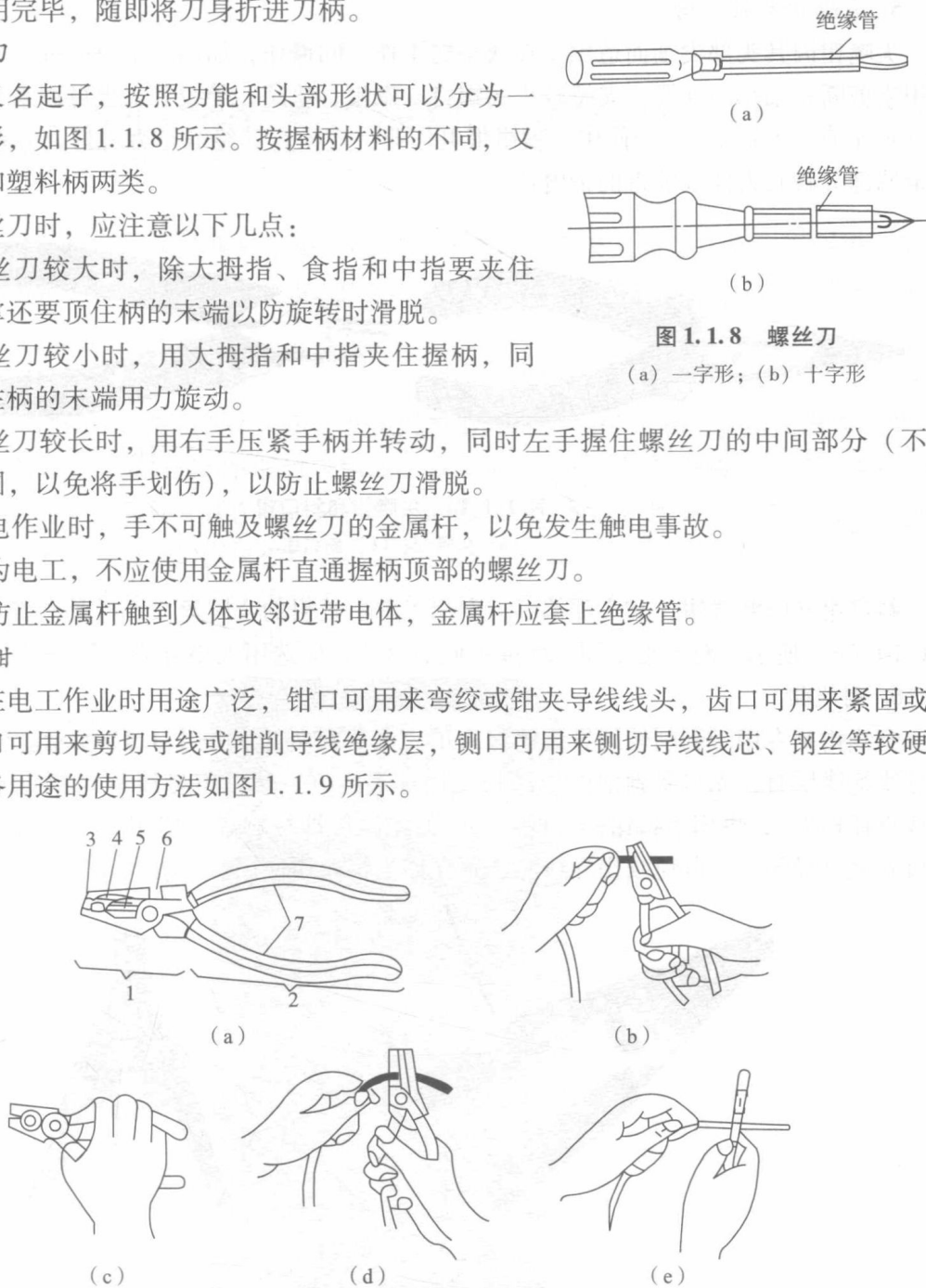
图1.1.9 钢丝钳的结构及用途
