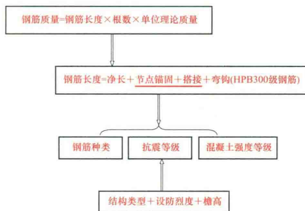
图 1.3 钢筋计算原理
