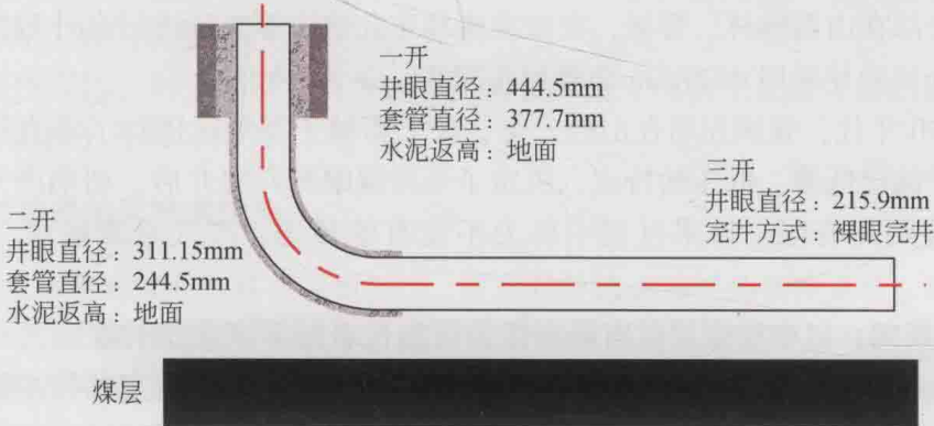
图 1.7 顶板“L”形采动井示意图
