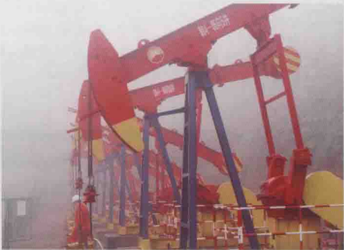
图 1.6 地面煤层气开发丛式井排采现场
