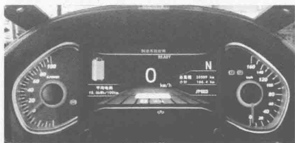
图 1-7 点火开关打开后仪表提示制动系统故障
