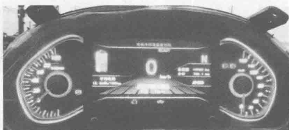
图 1-6 点火开关打开后仪表提示冷却系统故障
