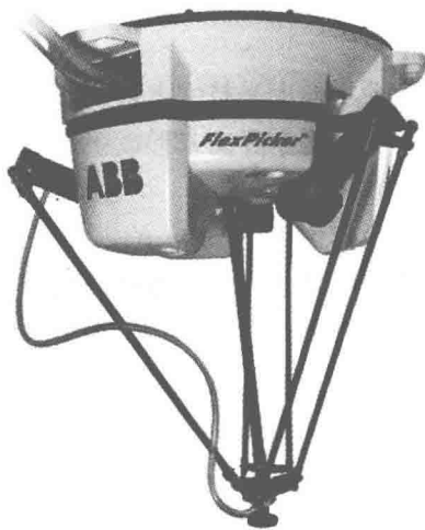
图 1-2 并联机器人 FlexPicker
