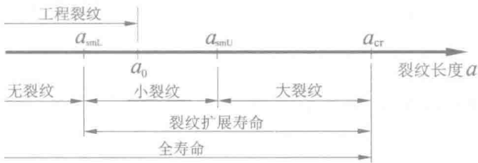
图 1.3 三阶段疲劳破坏模型
