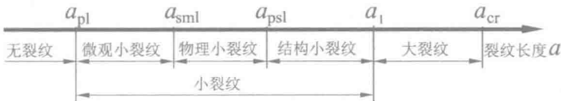
图 1.4 多阶段疲劳寿命模型
