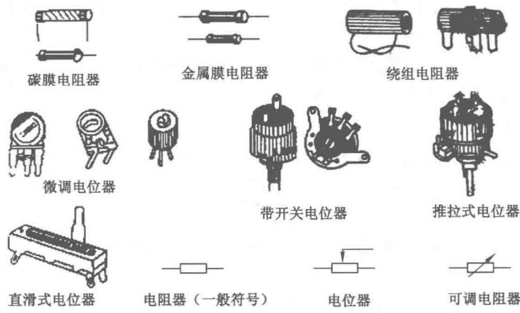
图 1-3-1 常用电阻器的外形及符号
