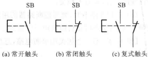
图 1-13 控制按钮的电气图形符号和文字符号
