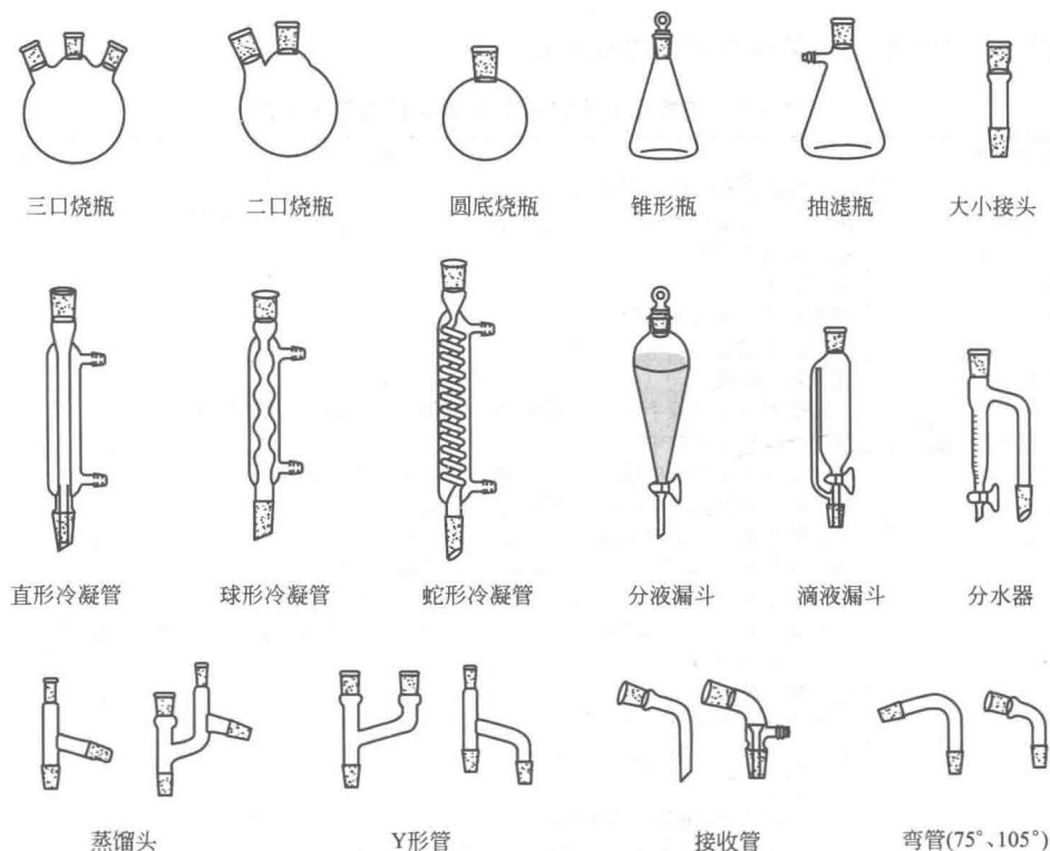
图 1-2 常用标准磨口玻璃仪器
