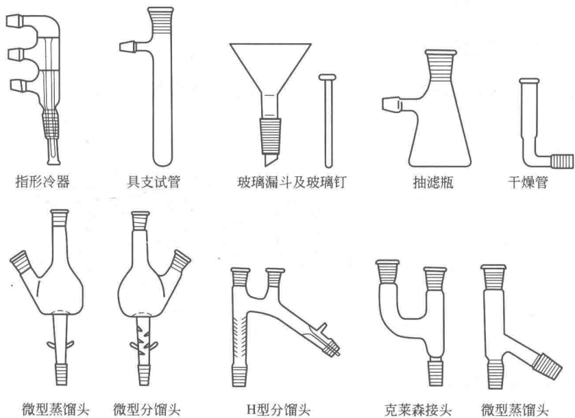
图 1-3 常用的微型磨口玻璃仪器
