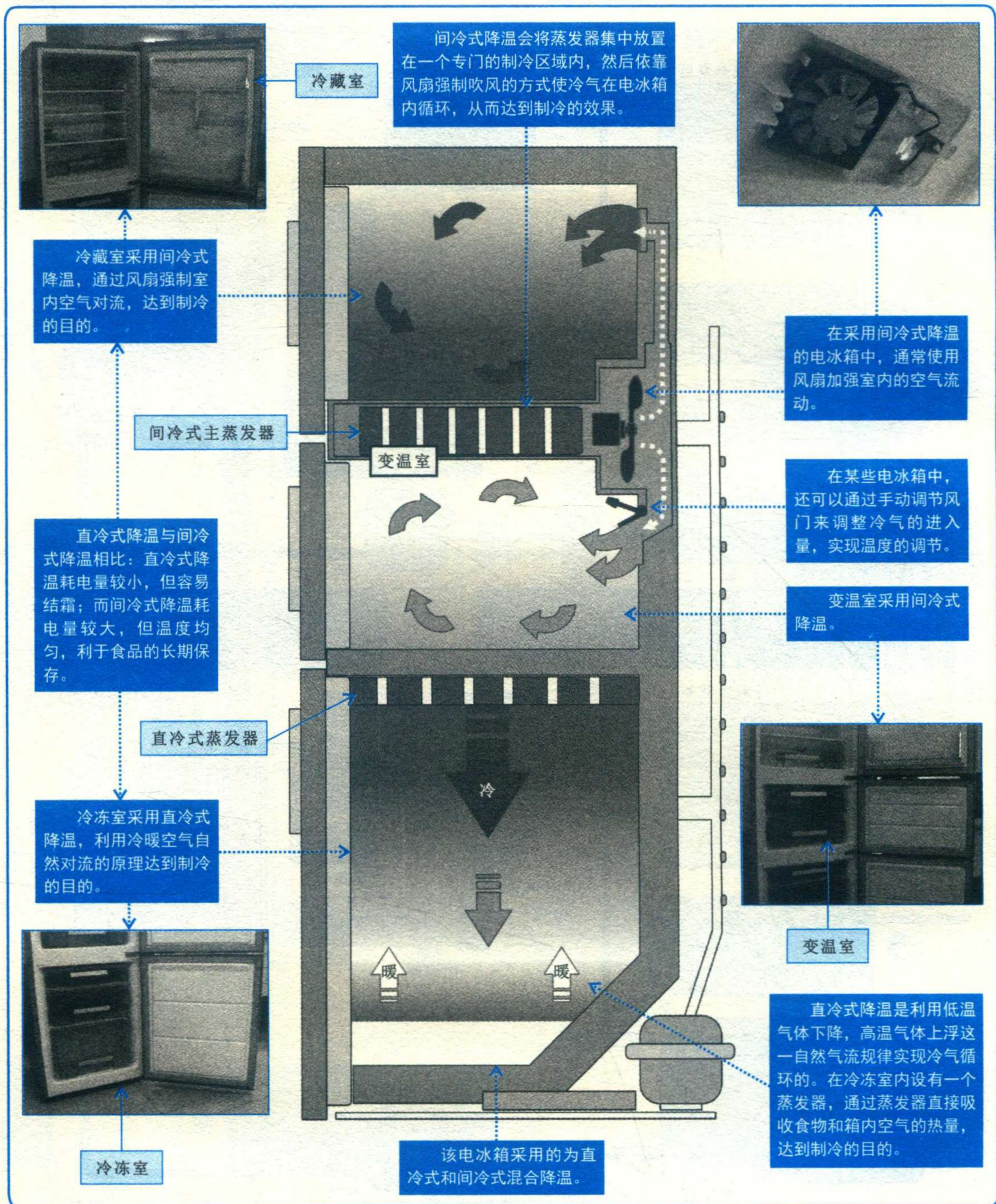
【电冰箱的冷气循环原理】
