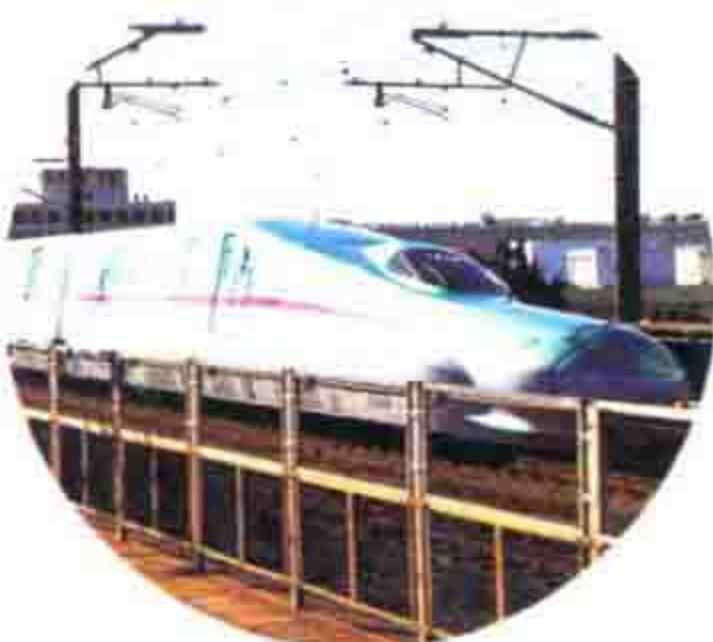
“隼鸟号”列车是日本新型的子弹头列车，车头长约15米，超过新干线原列车车头，以降低噪音，提高舒适性。非常值得大家体验。
