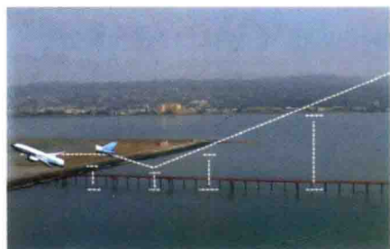
(a) 飞机下降角度偏小,尾翼撞击凸起的岸壁后解体
