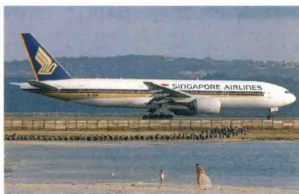
(b) 跑道两侧只设有简单隔离网,未设刚性障碍
