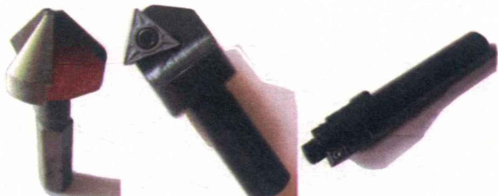
a) 高速钢锥角铤钻 b) 可转位锥角铤钻 c) 可转位平底铤钻
