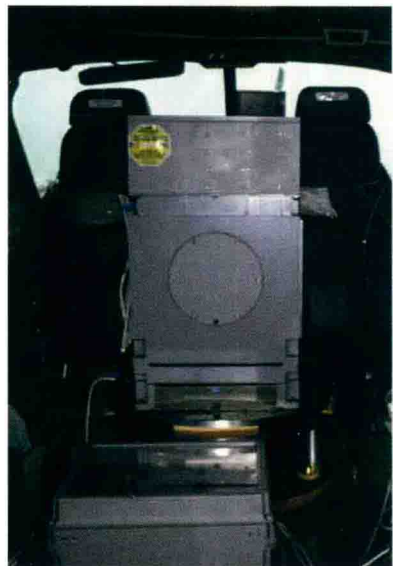
图1.3 安装在Cessna 208飞机上的GT-1A航空重力测量系统
