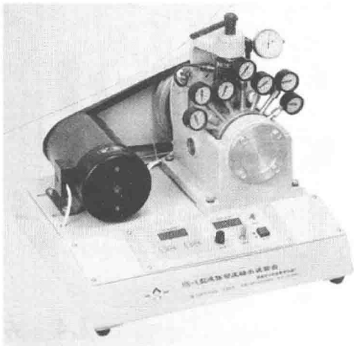
图 2-7 HS-A 型液体动压轴承实验台
