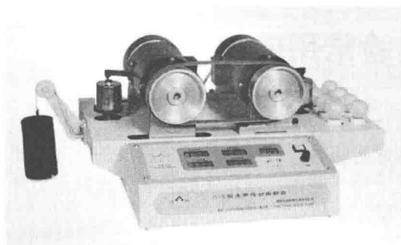
图 2-3 PC-B 型新型皮带实验台
