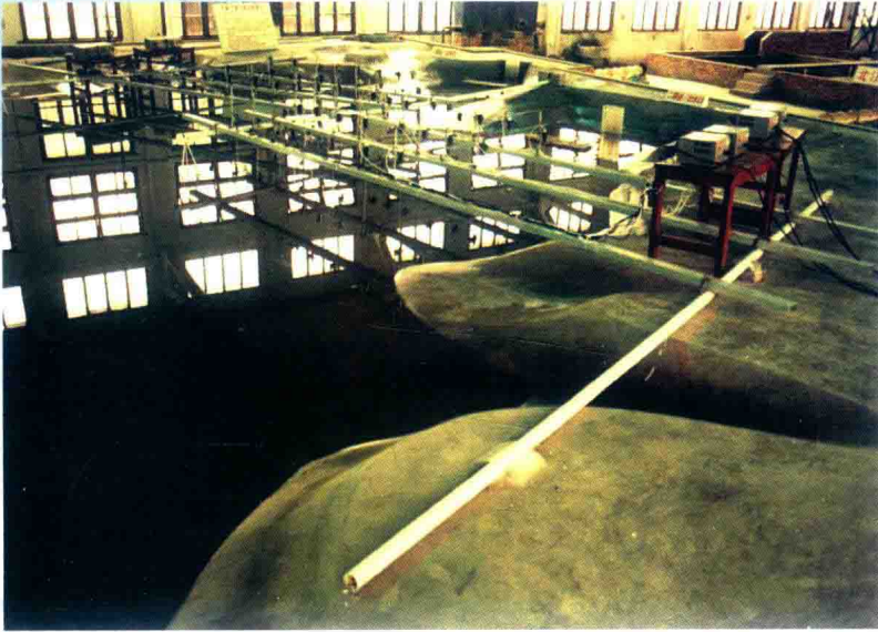
彩图 15 广州抽水蓄能电站下库进出水口水力模型试验
