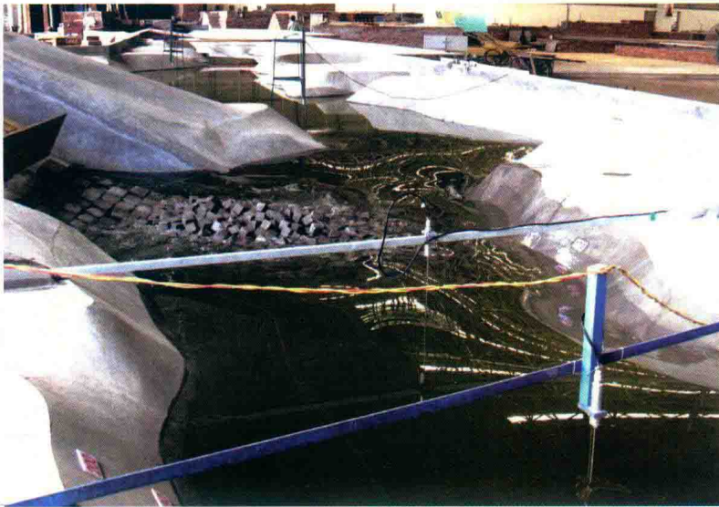
彩图 19 乐昌峡水电站库区鹅公带滑坡体滑坡涌浪试验
