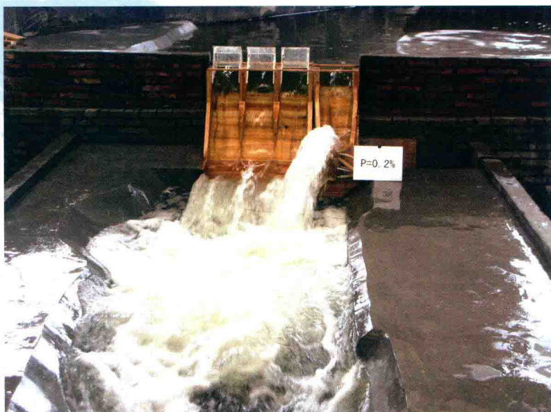
彩图 26 张公龙水电站溢流坝联合运行水力模型运行流态 (总泄流量 Q=2760\text{m}^3/\text{s} , 新增闸孔 Q_1=566\text{m}^3/\text{s} )
