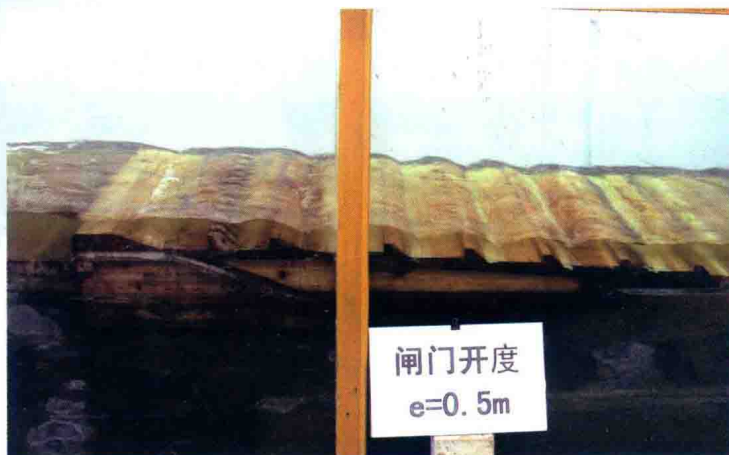
彩图 12 东山水闸（4号~12号闸孔）除险改造水力模型试验流态
