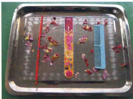
图二 用摩擦过的物体吸纸片
