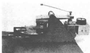
图 1-2 圆锯片辊压适张设备
