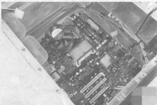
图 1.17 主板的安装(二)
