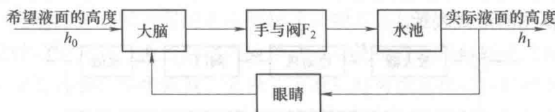
图 1-2 液面人工控制系统的框图
