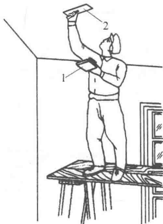
图 1.17 混凝土顶棚抹灰方法示意图
