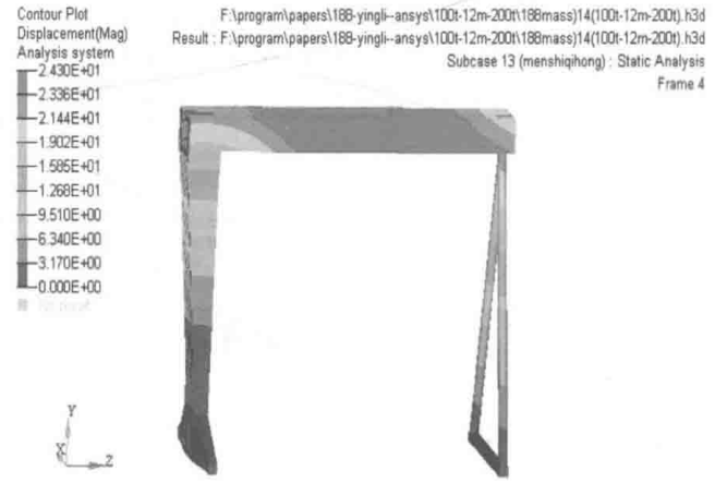
b) 工况4 门式起重机位移云图
