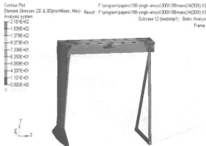
a) 工况5 门式起重机应力云图
