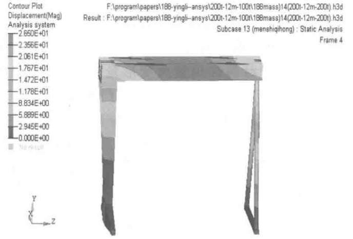
b) 工况3 门式起重机位移云图
