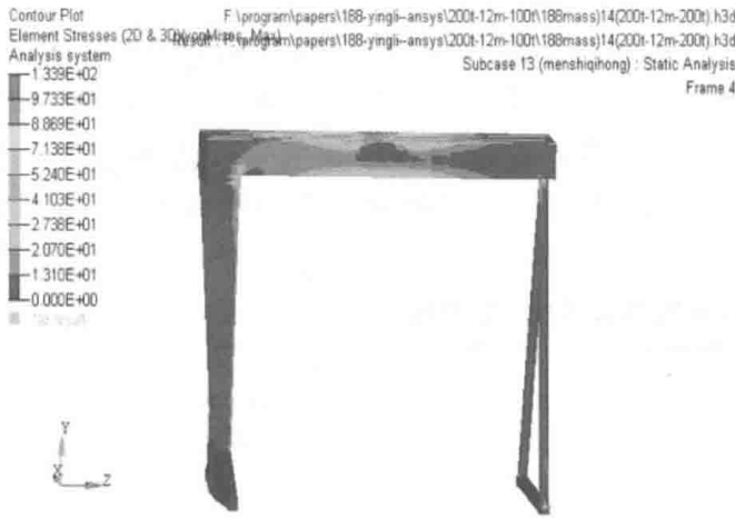
a) 工况3 门式起重机应力云图
