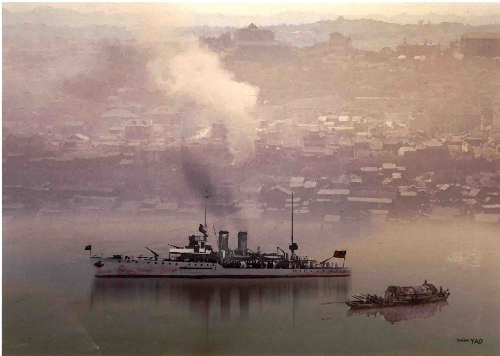
“民权”号在抗战时退守四川，卸除原来的 120 毫米主炮移交岸上炮台，艏艉各换装一门日本制“三年式”76 毫米高射炮，担任重庆防空舰以及各海校的练习舰。（请参阅“民权”/第 68 页）
