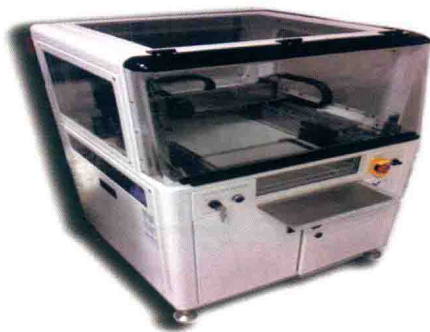
图 1.5 超声波扫描显微镜
