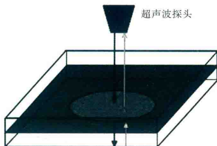
图 1.10 C-Scan 的工作原理
