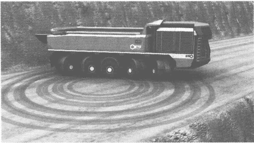
图 1.7 Mining Trucks MT-240 各轴轮胎转向轨迹示意图
