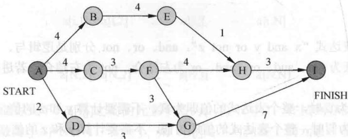
根据关键路径法,计算出关键路径为A—C—F—G—I,关键路径长度为17。因此里程碑C在关键路径上,而里程碑B、D和H不在关键路径上。
