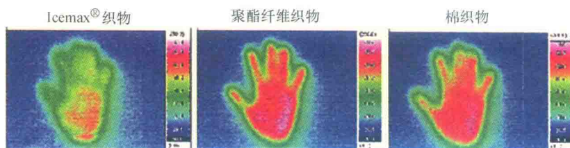
图 8-8 采用三种不同织物的手套使用后的热力图
